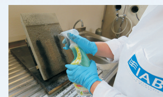
Versuche zum Reinigungseffekt der Oberfläche
