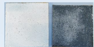
TiO_2 : Partikelübertragung von der Schalhaut
